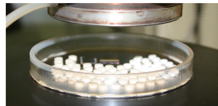
■ sugimoto-IMG_9939ts: プラズマを用いた医用材料の生体親和処理
