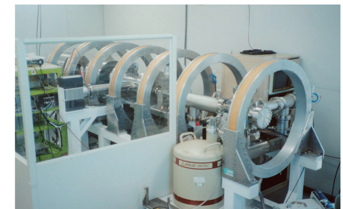
■私達が開発したエネルギー可変低速陽電子ビーム材料評価装置 任意のエネルギーに単色化した低速の陽電子ビームを試料中に入射させ、陽電子が試料内の電子と対消滅して放出するγ線のエネルギー分析を行って、表面・界面近傍のナノ構造欠陥の深さ分布を測定する装置。
