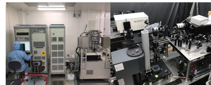
■超微細加工プロセス装置・光学特性評価システム 作製した半導体材料をデバイス化、或いは微細加工を施しナノ構造を作製し、レーザ照射や電流注入により励起・発光させ、光学特性を評価します。
